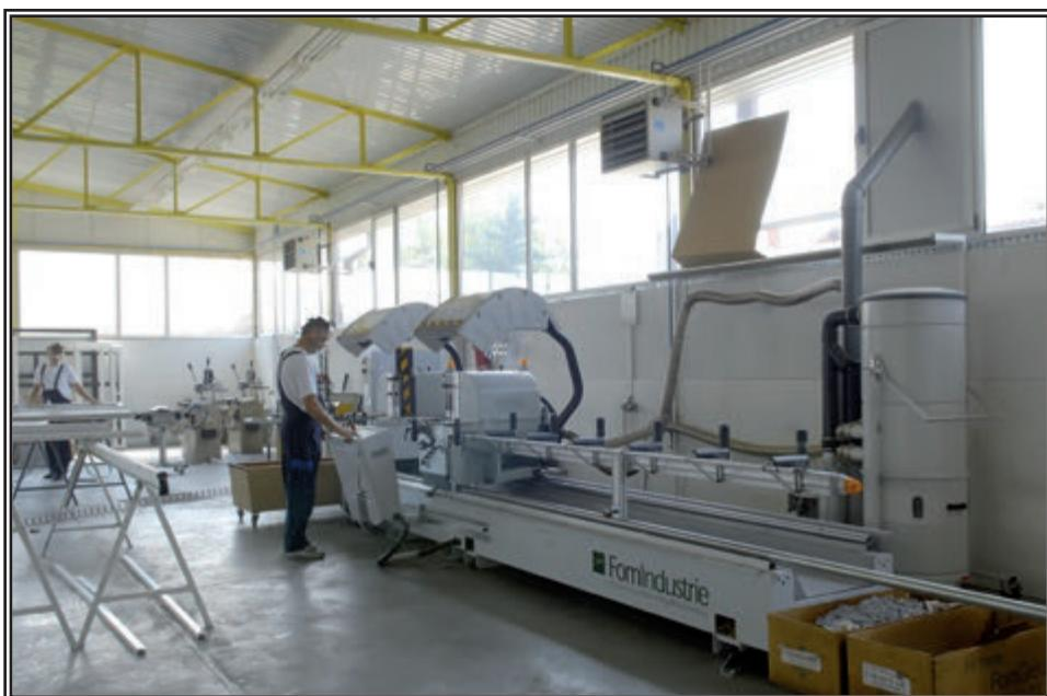
Automatische 4-Kopf und 4-Achsenlinie CNC zur Verschweisung und Reinigung von Profilecken
