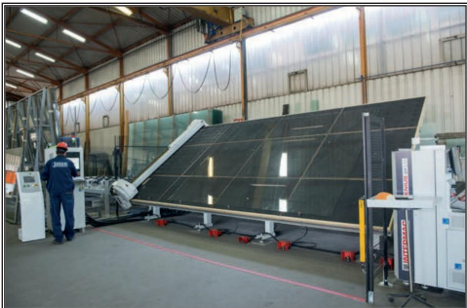
Automatischer Schneidungstisch für monolithisches Glas
