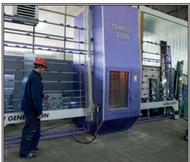
Automatische Maschine zur Sandstrahlung von Glas
