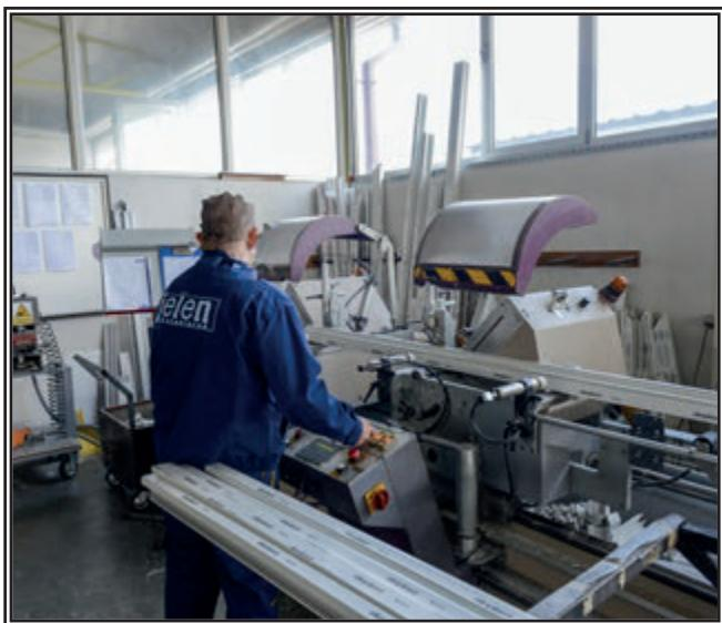
Automatische Linie zur Schneidung von Profilen
