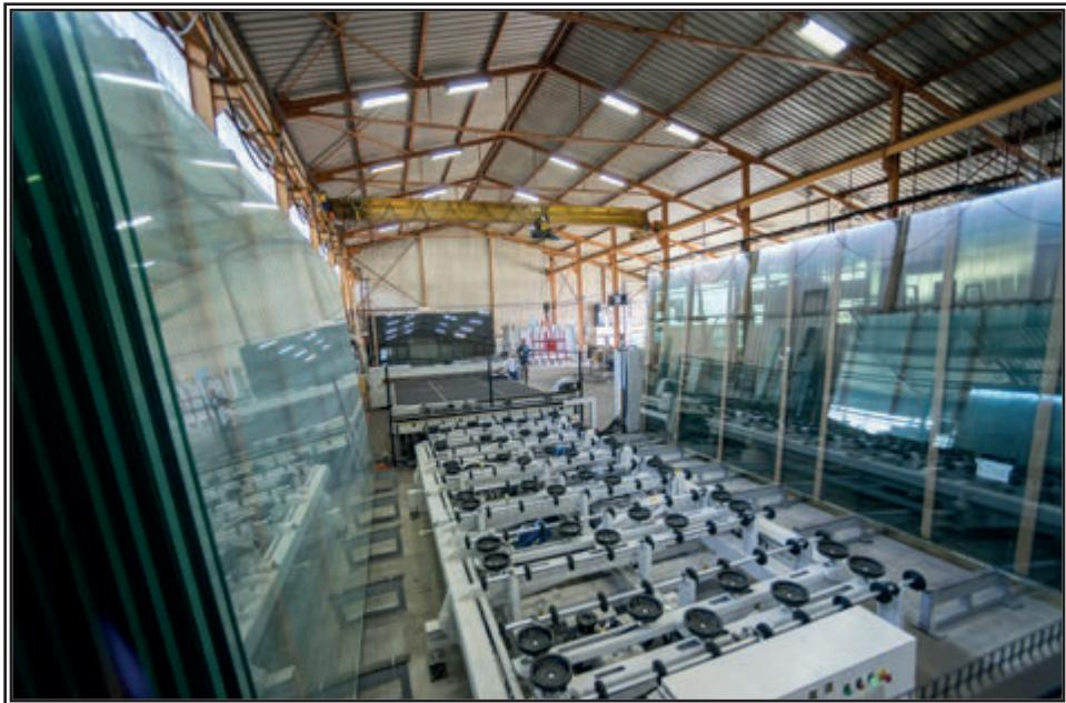
Automatische Linie zur Schneidung von monolithischem und laminiertem Glas JUMBO, mit dem Format 6000x3210 mm, der Kapazität von 1000 m<sup>2</sup> Glas in einer Schicht
