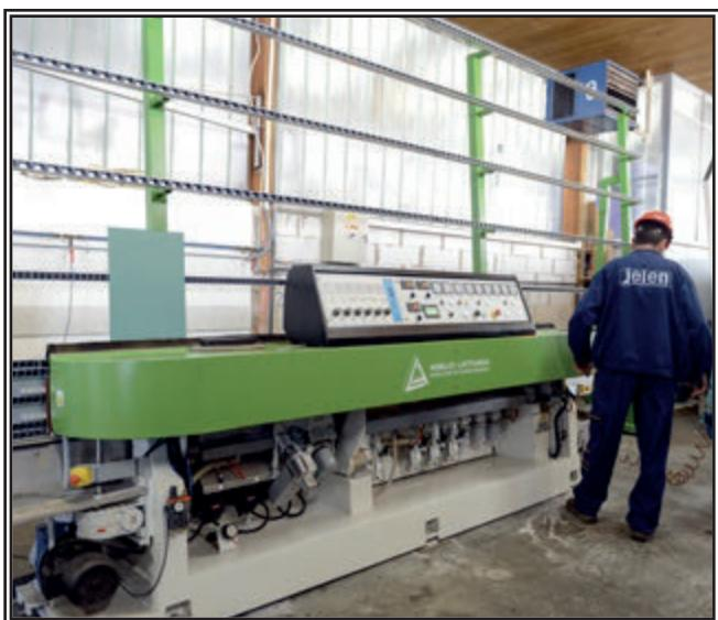
Schleif- und Poliermaschine für das Glas mit der Dicke von bis zu 36 mm mit der Möglichkeit der Eckschleifung
