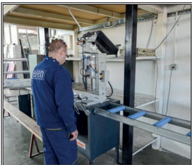
Automatische Linie zur Einfügung von Metallstärkungen in die PVC Profile
