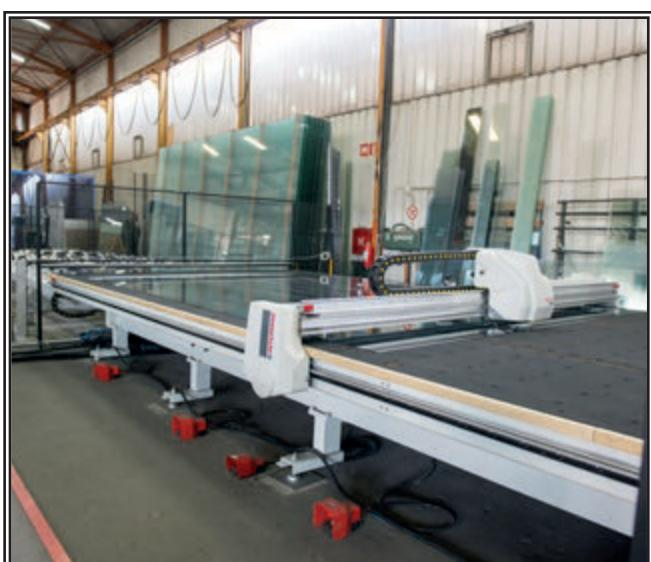
CNC Tisch zur Schneidung von monolithischem Glas
