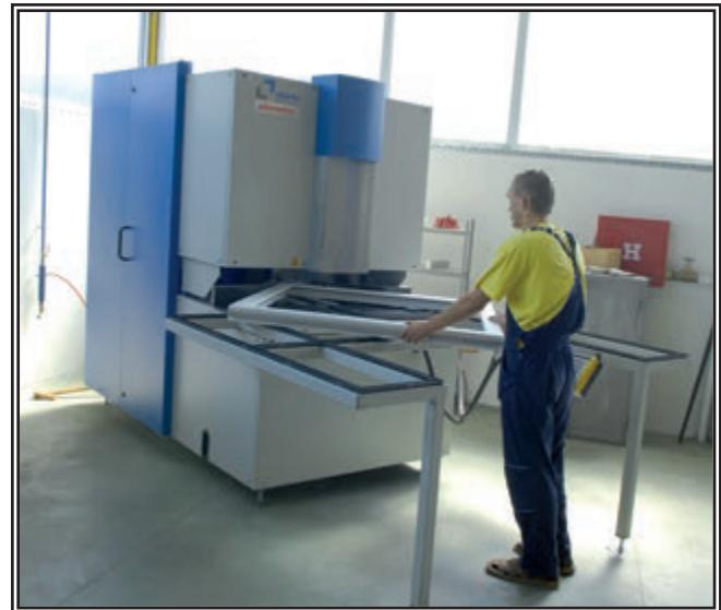
Automatische CNC Reinigungsmaschine zur Reinigung von Ecken an den PVC Profilen
